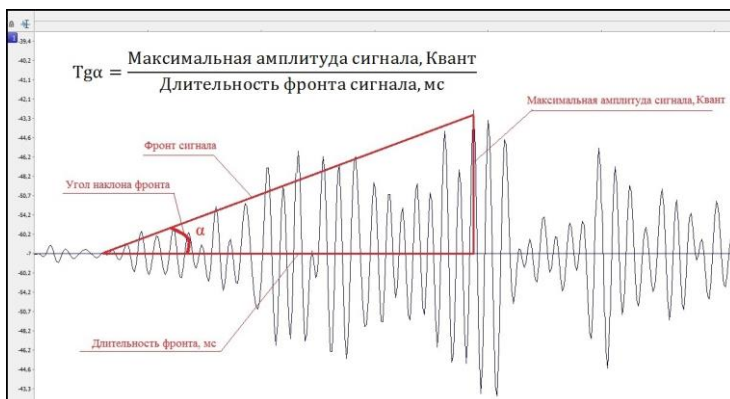
Рис. 1. Расчет тангенса угла наклона фронта импульса
