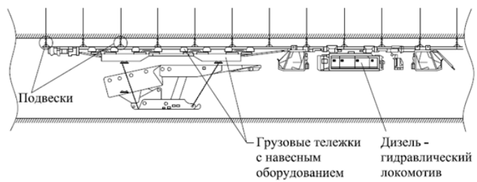
Рис. 2. Действующая схема (способ) подвески груза подъемным устройством гидравлическим (гидроподъемниками)
