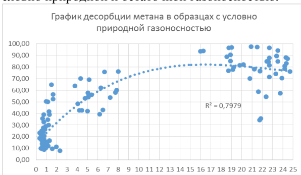
Рис. 1. График десорбции метана из угольных проб пластов Болдыревский и Поленовский с условно природной газоносностью
