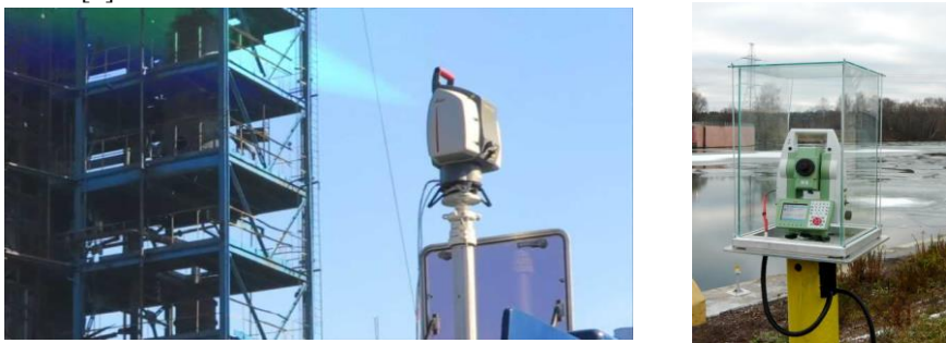
Рис. 2. Автоматизированная система наблюдения за деформациями инженерных сооружений
