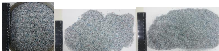
Рис. 1. Вид отсева на сите, фракции -3+2 мм и -2+1 мм
